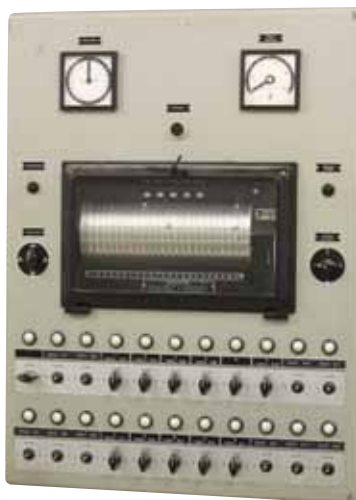
Steuerung Netzkommandoanlage aus den sechziger Jahren
